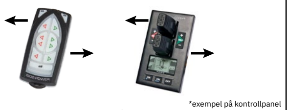
Körning av både bog- och akterpropeller för att rotera båten runt sin egen axel
